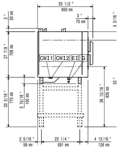
CWI1 = Kaltwasserzulauf                      EI = Elektroanschluss
